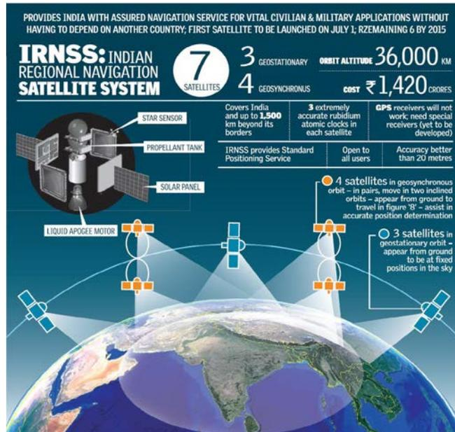
Fig. 1. IRNSS Schematic
